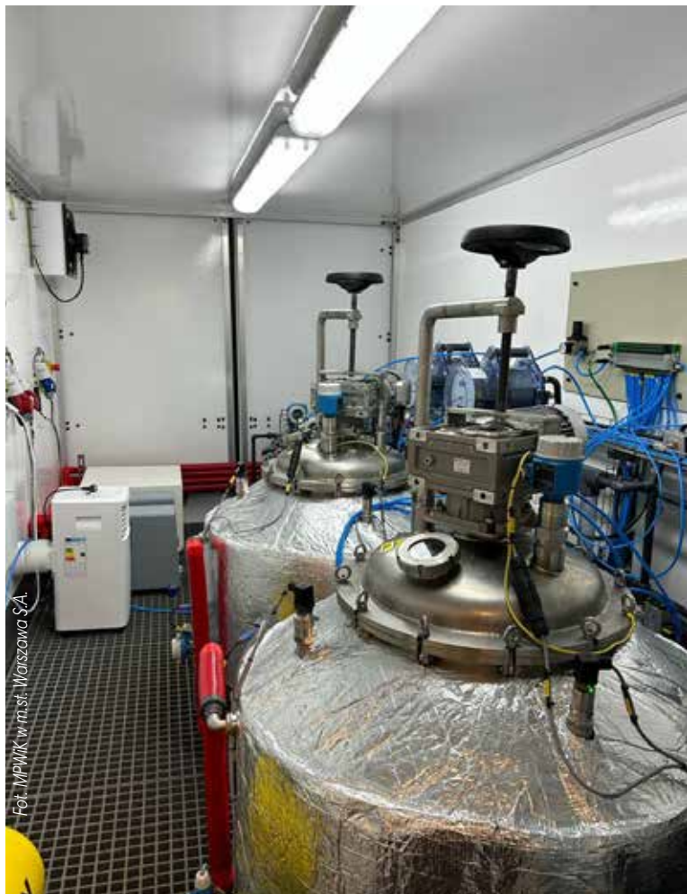
FOT. 2 Stacja pilotażowa procesu kofermentacji, umożliwiająca badanie procesu w skali ułamkowo-technicznej
