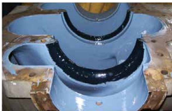
FOT. 6 Korpus pompy po wypełnieniu wżerów kompozytem Belzona®1311, modernizacji powłokowej Belzona®1341 i zabezpieczeniu przeciw kawitacji powłoką Belzona (źródło: Archiwum Belse Sp. z o.o.)
