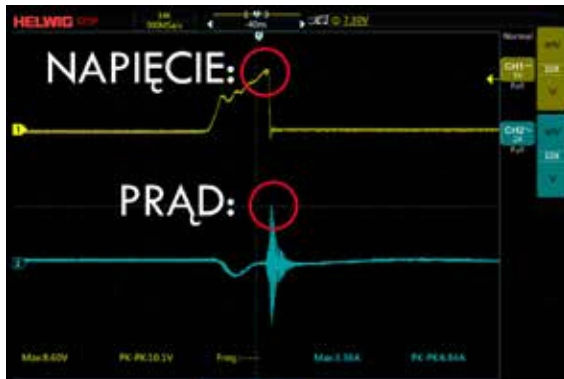
RYS. 9 Chwilowy wzrost napięcia wałowego
