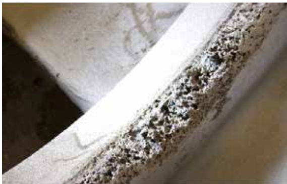
FOT. 5 Wżery kawitacyjne w warstwie wierzchniej korpusu pompy (źródło: Archiwum Belse Sp. z o.o.)
