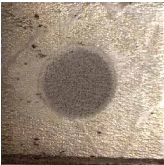
FOT. 3A Próbka stopu Cu-Ni. Widok po ekspozycji na stanowisku wibracyjnym (źródło: Laboratorium maszyn przepływowych VOITH Turbo Sp. z o.o.)
