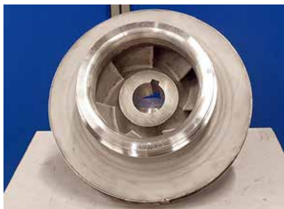
FOT. 3 Wirnik wykonany przez NAN z proszków metalowych Mimete Srl [7]
