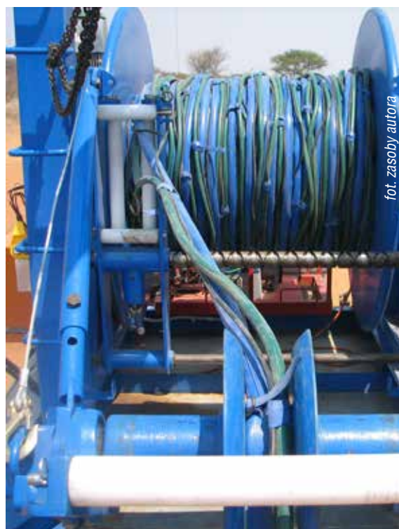
FOT. 3 Zabudowa wykorzystująca bęben montażowy z nawiniętym przewodem wraz z kablem
