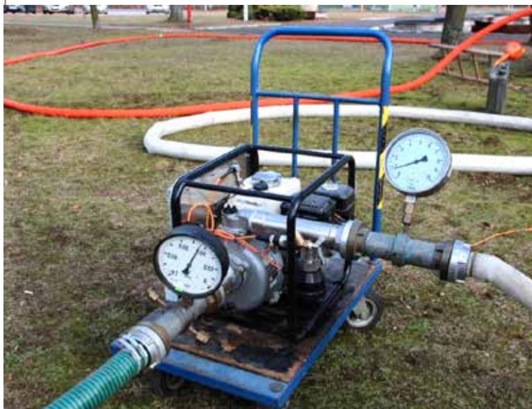
FOT. 2 Badanie motopomp do wody czystej (źródło: Archiwum CNBOP-PIB)
