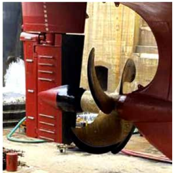
FOT. 4 Powłoka Belzona®2141 zastosowana do ochrony przed kawitacją steru i śruby okrętowej (źródło: Archiwum Belse Sp. z o.o.)
