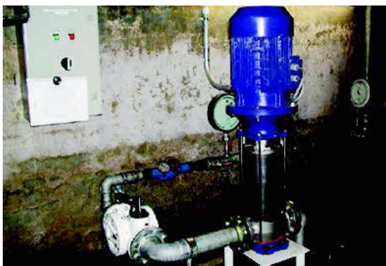
FOT. 1A Stanowisko testowe do pomiarów czasu zainicjowania erozji kawitacyjnej powierzchni (źródło: Laboratorium maszyn przepływowych VOITH Turbo Sp. z o.o.)
