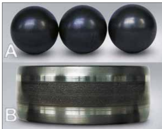
RYS. 12 Wyżłobienia spowodowane erozją elektryczną
