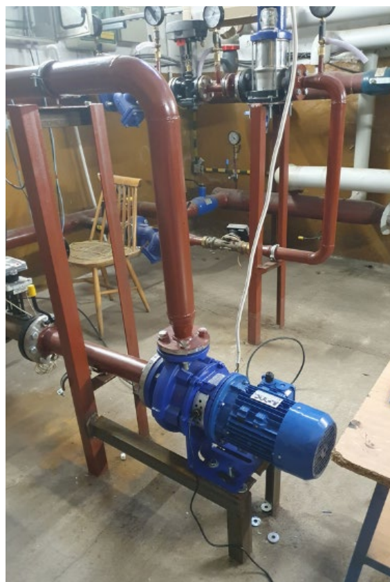
FOT. 2 Stanowisko do badania turbin z wałem poziomym
