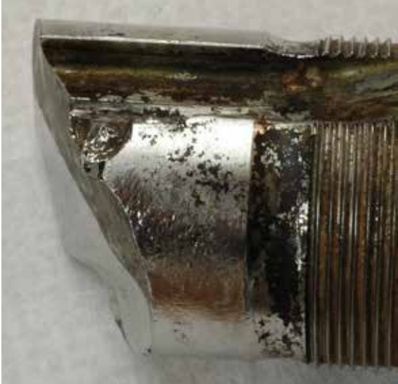
RYS. 4 Całkowita dezintegracja wału pompy spowodowana drganiami skrętnymi
