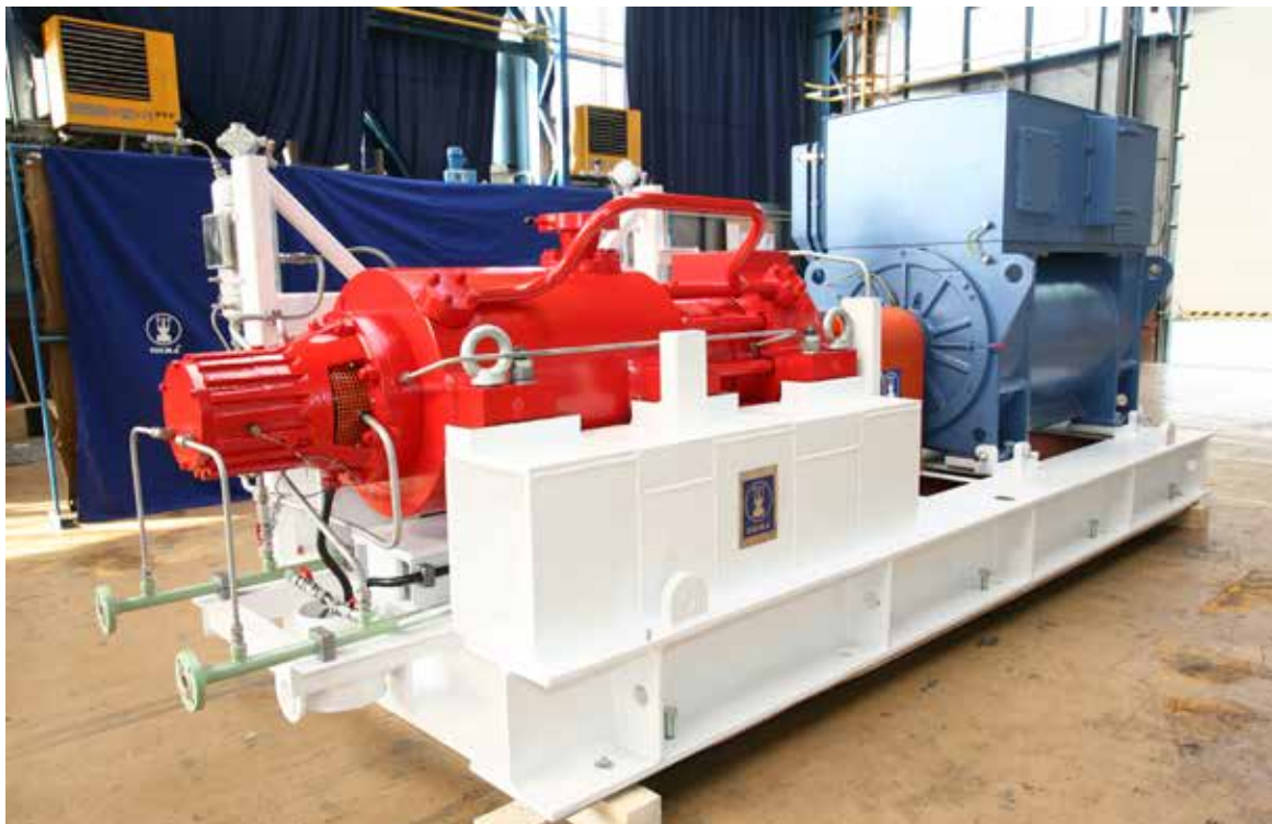
EMO34, WYSPA JĄDROWA KDX-3, pompa awaryjnego chłodzenia wyspy jądrowej, wysyłka
