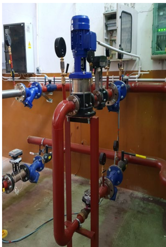
FOT. 1 Stanowisko do badania turbin z pionowym wałem
