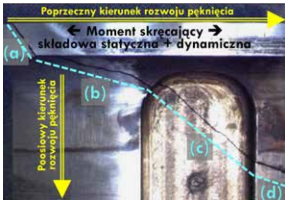
RYS. 3 Częściowa dezintegracja wału pompy
