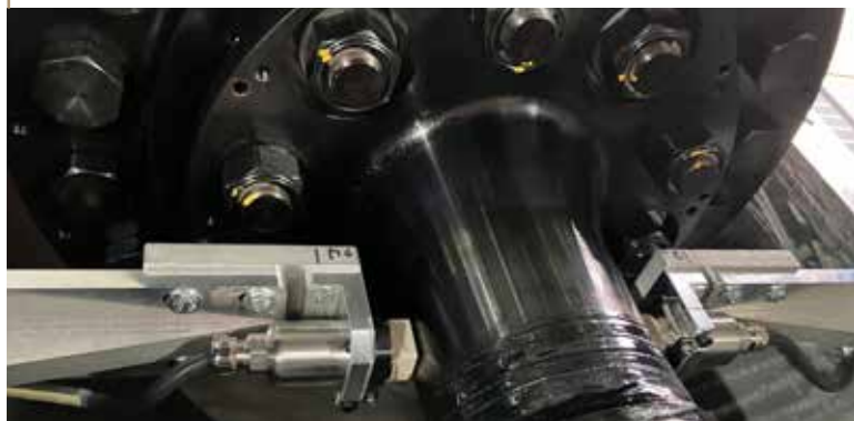
RYS. 20 Czujnik drgań skrętnych VORSO zainstalowany na maszynie
