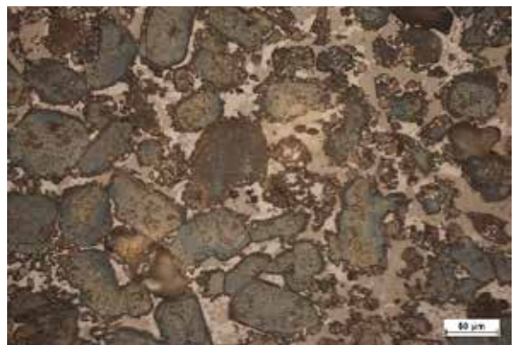
RYS. 6 Ziarna drobne. Powiększenie 500x. Sekcja polerowana, wytrawiona nitałem. Drobne kryształy belitu wokół ziaren alitu. Faza wypełniająca równomiernie rozłożona
