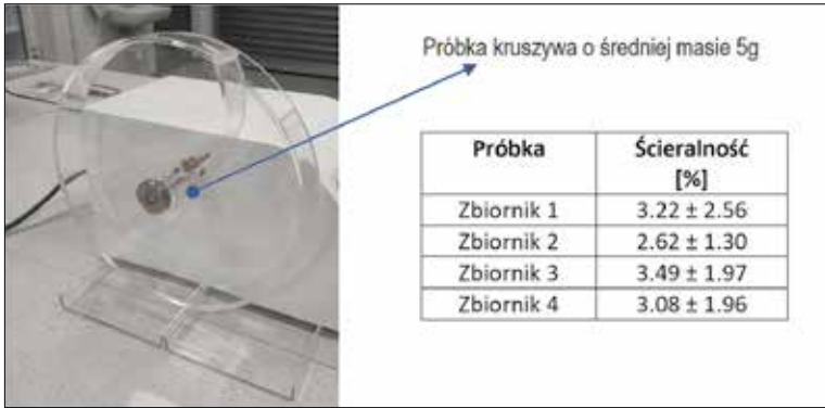
RYS. 6 Badanie ścieralności kruszywa lekkiego
