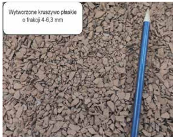
FOT. 3 Kruszywa uzyskane po wysuszeniu, rozdrobnieniu w kr. szczękowej, wysianiu w przesiewaczkach i po wypaleniu w 1050°C
