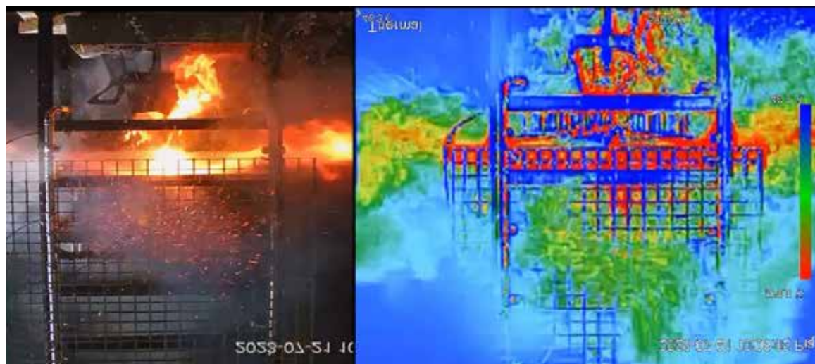
RYS. 3 Widok palących się modułów i rozkład temperatury uzyskany za pomocą kamery termowizyjnej w teście 2 (źródło: zasoby własne autorów)
