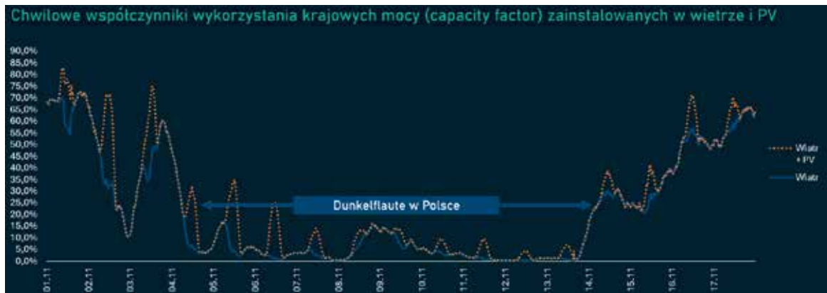
RYS. 2 Chwilowe współczynniki wykorzystania mocy zainstalowanych w wietrze i PV (źródło: opracowanie własne na podstawie danych PSE, ENTSO-E)
